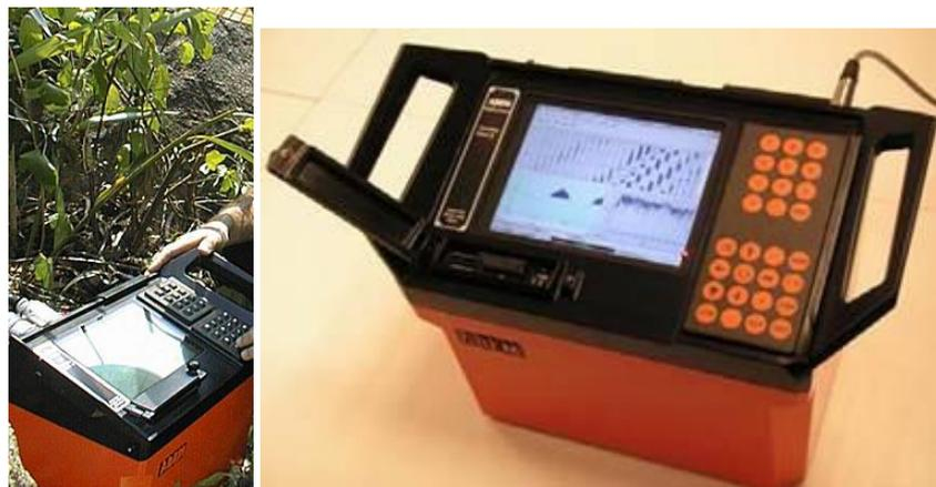
Permite discriminar los diferentes terrenos que constituyen el suelo en una zona concreta en función de sus propiedades elásticas (Velocidades sísmicas  $V_p$  y  $V_s$ ).
