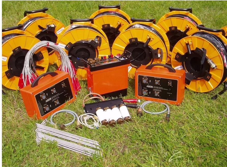
Permite diferenciar los distintos terrenos que constituyen el subsuelo en función de sus características geo-eléctricas
